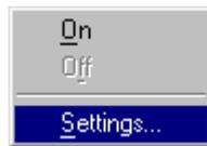
شکل 1-19-9) تقة راست روی دکمه‌های Grid, Ortho, Polar, Osnap, Otrack و LWT در نوار وضعیت. برای Ortho گزینه Settings... همیشه خاموش است.
