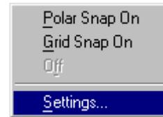
شکل 1-19-8) تقة راست روی دکمه Snap در نوار وضعیت
